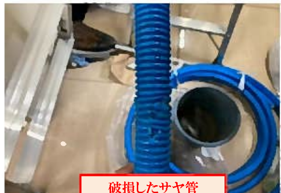
壁内の破損サヤ管(中に給水管)
